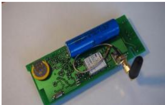
Плата извещателя вынута из корпуса: синего цвета – буферный аккумулятор, желтого цвета – батарейка часов, крепление SIM-карты на другой стороне.
