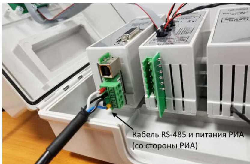
Подключение кабеля интерфейса RS485 на клеммы-разъемы регистратора, корпус БИП открыт
