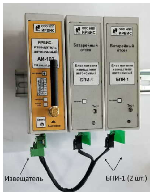
Монтаж на стену Извещателя с блоками питания БПИ-1, на DIN-рейку.
