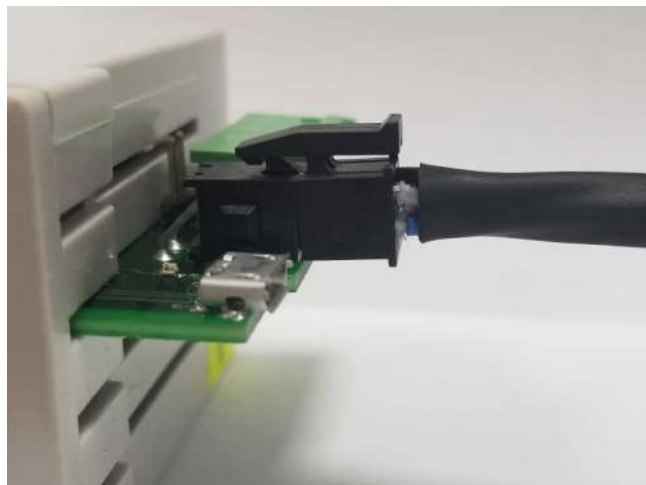
Пример правильной коммутации кабеля питания к блоку АИ-102 - защелка должна быть расположена со стороны разъема напротив платы, не сбоку!
