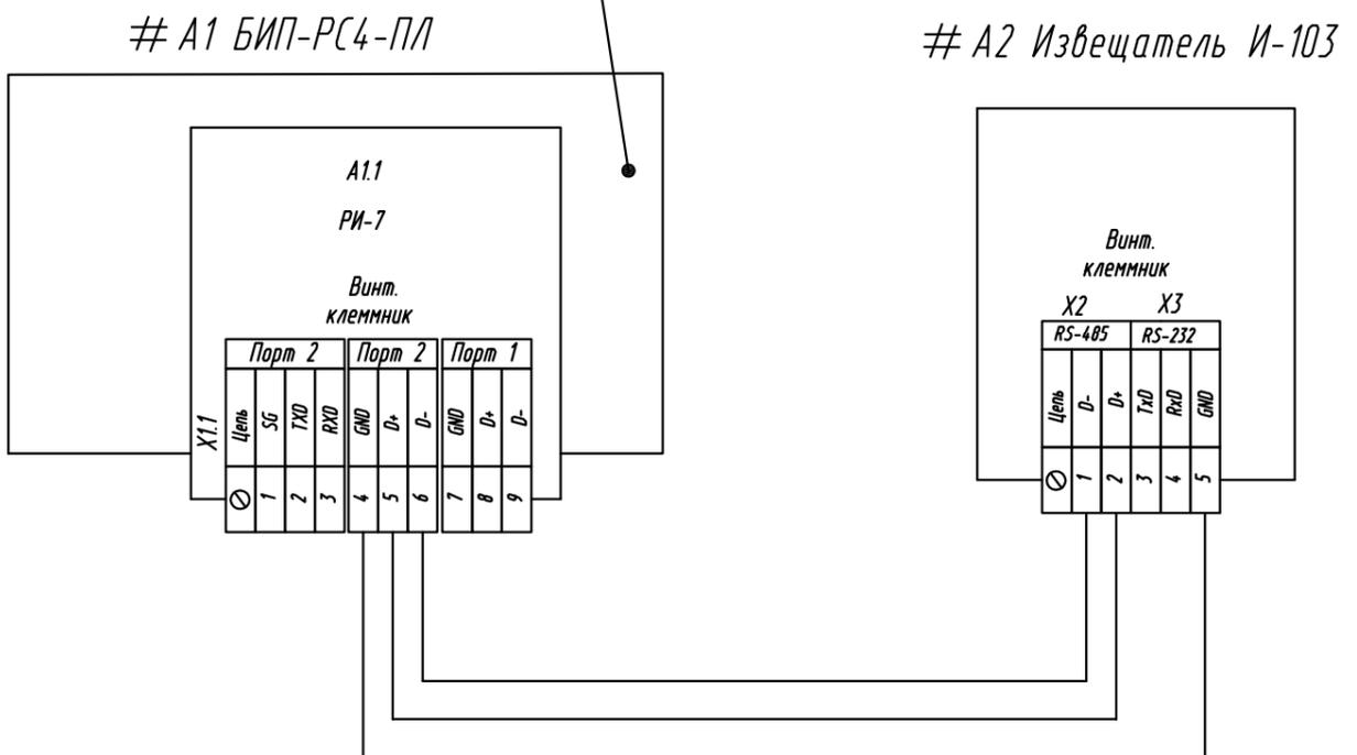
**5. Схема подключения извещателя И-103 к порту 2 (клеммы RS-232) регистратора РИ-7**
