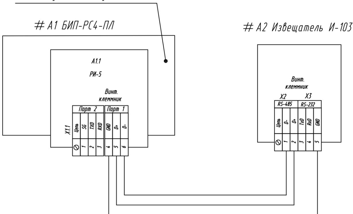
**2. Схема подключения извещателя И-103 к порту 2 (клеммы RS-232) регистратора РИ-5**
